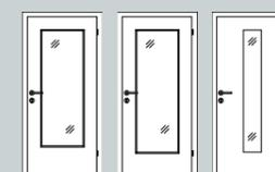
Wohnungseingangselemente der Schallschutzklassen 1 (Flur in Flur) und 3 (Flur in unmittelbaren Aufenthaltsraum) sind bei uns immer in Klimaklasse III (20 Grad Differenz) ausgeführt. Wir führen alle Modelle in den Breiten 860 und 985 mm am Lager.
