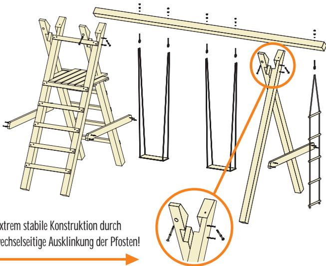
Extrem stabile Konstruktion durch wechselseitige Ausklinkung der Pfosten!
