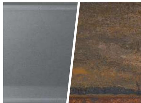
Naturstein, Beton, Fliesen etc. zum Teil sehr hartnäckige Verfärbungen hinterlassen werden. Vermeiden Sie den direkten Kontakt der Umgebung mit dem Ablaufwasser der Zaunelemente durch Abdecken oder baulichen Objektschutz, da die wiederkehrende, notwendige, oberflächenspezifische Reinigung sehr aufwendig ist und vielfach nicht erfolgsversprechend sein wird. Diese Verfärbungen werden nicht als Beanstandungsgrund anerkannt.
