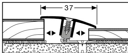
Schraub Übergangprofil 7-17 / 27 mm
