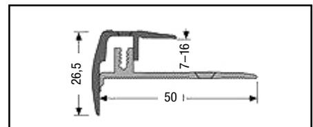
PF 320 Treppenkantenschiene 7-16 mm
