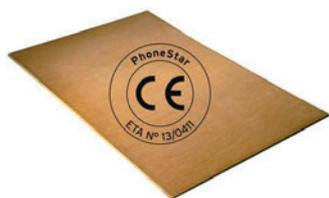
**PhoneStar** besteht im Wesentlichen aus schweren Massen in ungebundener Form. Aus biologisch reinem, gebranntem Quarzsand, verpackt in einem dreiwelligen Karton, der nach dem Sperrholzprinzip aufgebaut ist. Die Schallwellen müssen 7 Lagen Papier und 6 Schichten Sand durchdringen und verlieren dadurch ihre Energie. PhoneStar ist für **Allergiker geeignet**.
