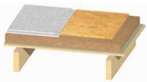
GUTEX Thermosafe-wd<sup>®</sup> auf offener Balkenlage
