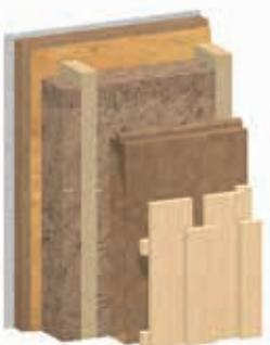
Hinterlüftete Konstruktion auf Holzständer mit Gefachdämmung GUTEX Thermofibre<sup>®</sup>/ GUTEX Thermoflex<sup>®</sup> sowie GUTEX Multitherm<sup>®</sup> hinter Holzfassade
