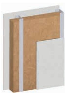
Leichte Metallständertrennwand mit GUTEX Thermofibre<sup>®</sup>/ GUTEX Thermoflex<sup>®</sup>/ GUTEX Thermosafe-homogen<sup>®</sup>
