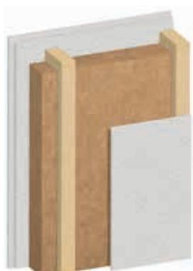
Leichte Holzständertrennwand mit GUTEX Thermofibre<sup>®</sup>/ GUTEX Thermoflex<sup>®</sup>/ GUTEX Thermosafe-homogen<sup>®</sup>
