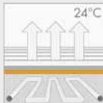
Je niedriger der Wärmedurchlasswiderstand der Dämmunterlage, desto weniger wird der Wirkungsgrad der Fußbodenheizung beeinflusst.
